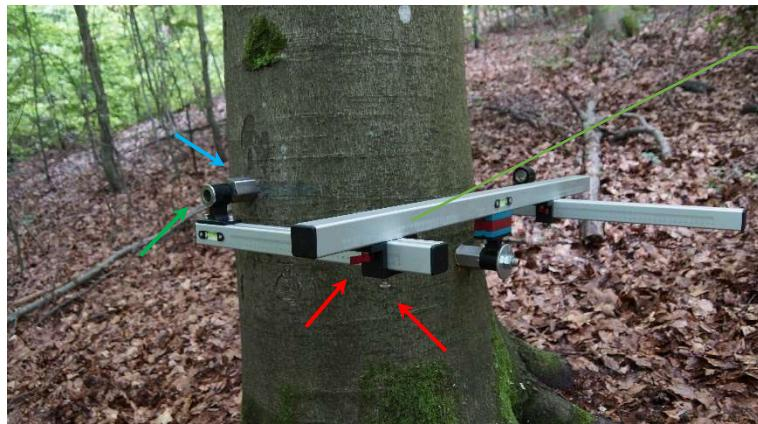
Desserrez les vis de serrage et alignez la douille de perçage sur la vis de plateforme .
