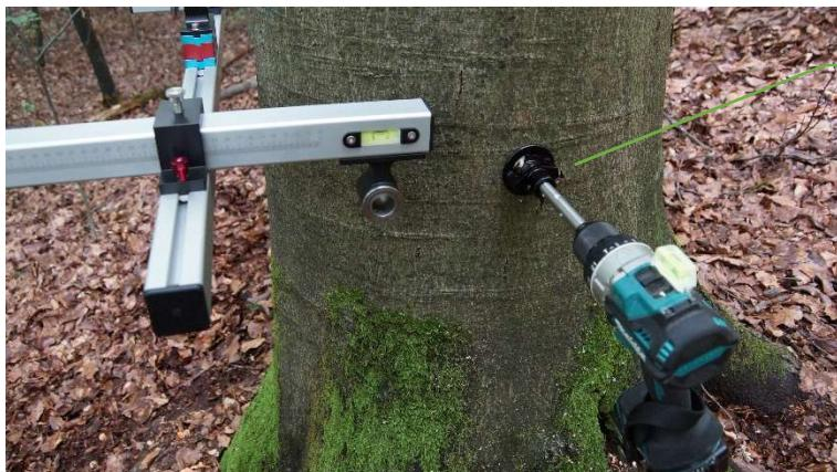
Insérer le deuxième et le troisième boulon de plateforme en tenant compte du mode d'emploi d'installation des boulons de plateforme (« Rev A // 06-06-2024 ») installer.
