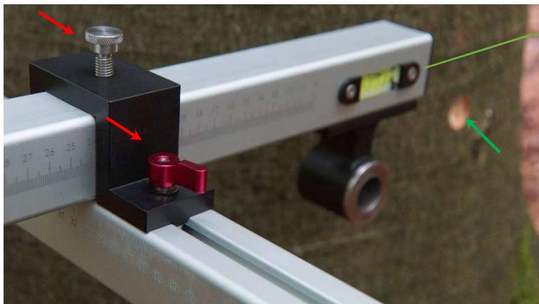
Dévisser les vis de serrage et retirer les bras de la **zone d'œuvre**.
