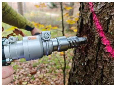
2.3.9 Bolzen mit Akkuschauber + Drehmomentverstärker eindrehen.
