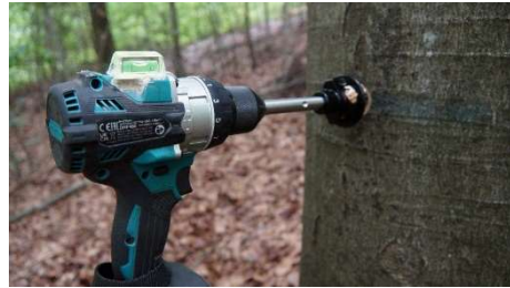
2.3.2 Loch bis zur gewünschten Tiefe bohren.
