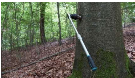
2.3.7 Bolzen mit Teleskop-Ratsche bis in die Endposition eindrehen.
