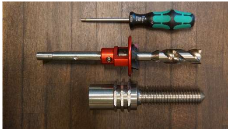
2.3.1 Multibohrwerkzeug auf Schraube einstellen.
