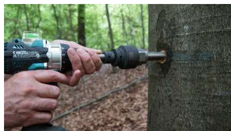
2.3.6 Bolzen mit Akkuschauber waagrecht ansetzen.
