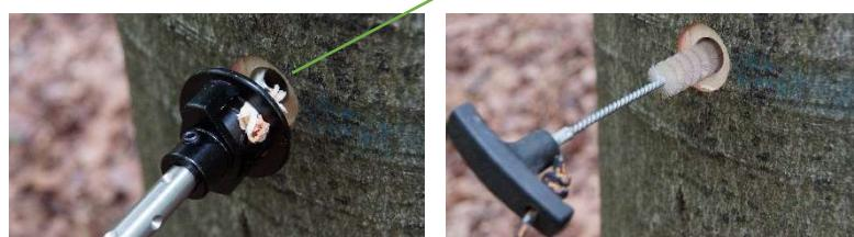
Réaliser le perçage d'étape, nettoyer le trou de perçage, désinfecter le trou de perçage, introduire la résine, visser le boulon de plateforme.
