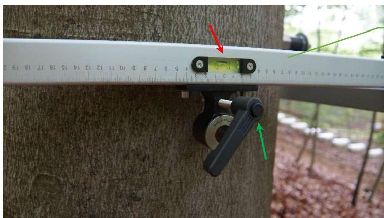
Aligner les bras latéraux à l'aide des niveaux à bulle et les fixer au tronc avec l'unité de centrage.
