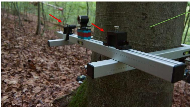
Guides des bras régler sur la mesure relevée de la graduation opposée.
