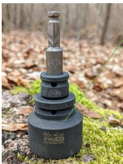
Douille SW 41 avec réduction et adaptateur pour le montage des vis-boulons pour arbres.
