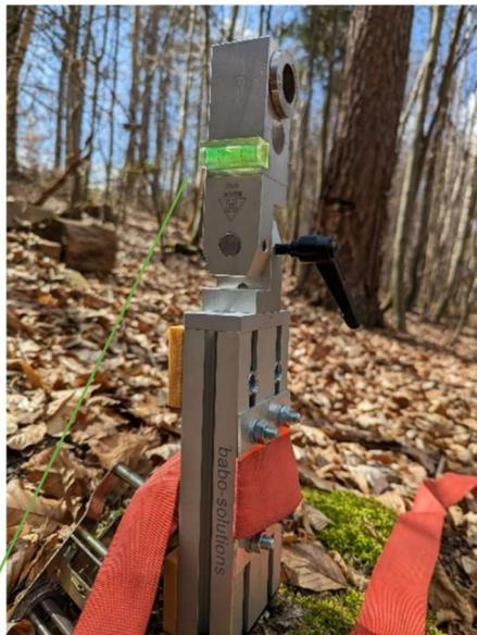
Niveau à bulle pour réaliser un perçage horizontal.
