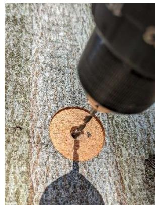
2.6.1 Avec une mèche à piquets Ø 40 mm préparer une surface plane.
