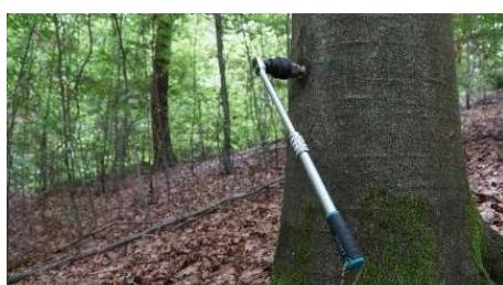
2.3.7 Visser la goupille à l'aide d'un cliquet télescopique jusqu'à la position finale.
