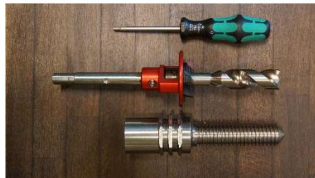
2.3.1 Régler l'outil de perçage multiple sur la vis.
