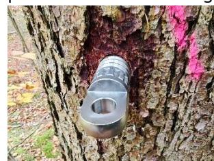
2.3.10 Visser la goupille jusqu'à ce que la surface de chargement médiane soit orientée vers le bas. Les languettes sont vissées à l'horizontale.
