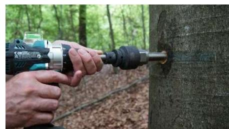
2.3.6 Positionnez la vis-boulon horizontalement à l'aide d'une perceuse-visseuse.
