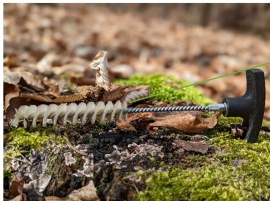
brosse de trou Ø adaptée au forage. Utilisée pour débarrasser le trou ou de perçage des copeaux de bois. brosse à trous — à désinfecter avant usage!
