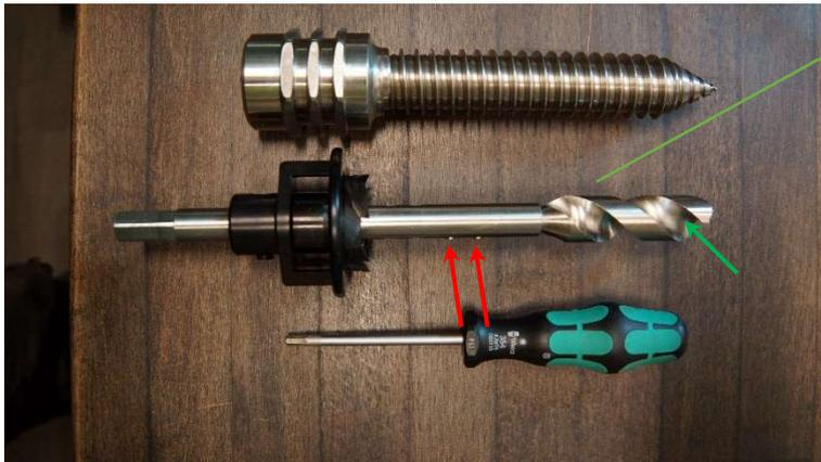
Sélectionner le diamètre d e perçage adapté à la vis.
