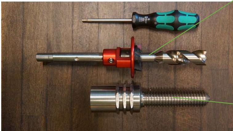
IMPORTANT : avant de serrer les d eux vis six pans, aligner la surfac e de la tige du foret (section hex agonale à 6 pans) perpendicula irement aux deux vis six pans.
