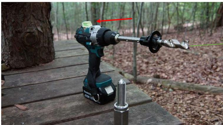
La position du fraiseur et de la butée de profondeur peut être ajustée en desserrant les deux tarauds (madenschraube n) pour s'adapter à la longueur d e la vis.
